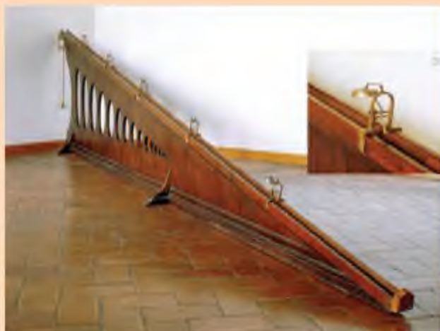
Hình 16. Dụng cụ "mặt phẳng nghiêng" đo quãng đường di chuyển sau mỗi khoảng thời gian đều nhau của Galilei tại Bảo tàng Galilei, nước Ý
